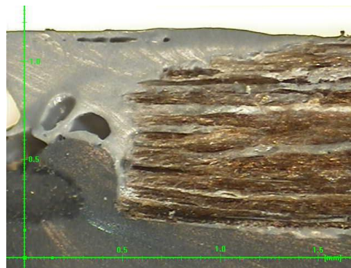
HIF fólie – vzhled vměstků ve vrchní vrstvě výrobku
